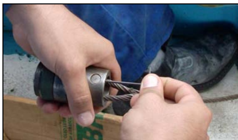
Figura 6: Pistão que faz o vácuo necessário para a penetração do equipamento.
