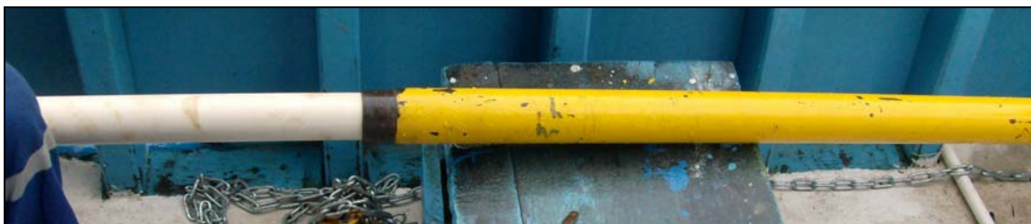
Figura 4: Colocação do Tubo de PVC dentro to tubo de aço.
