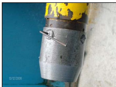
Figura 5: Cortador colocado na ponta do tubo de aço para facilitar a penetração.
