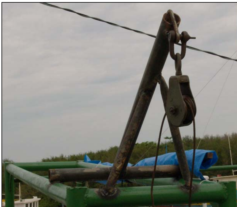
Figura 7: Pau de carga montado na borda da embarcação para o lançamento do equipamento.
